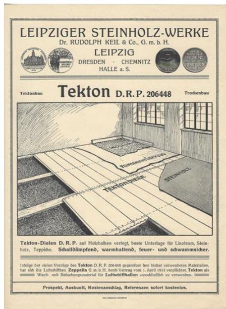
Prospekt für Tekton-Dielen der Leipziger Steinholz-Werke. Hier wird bereits ein Steinholzestrich dargestellt und es wird auf die Verwendung beim Bau von Luftschiffhallen verwiesen.
